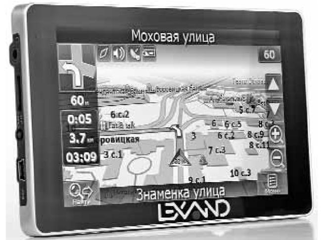
кнопкой «Путь навигации». Управляется Lexand SM-527 современной операционной системой Windows CE 6.0. Работает устройство на процессоре с частотой 600 МГц. Объем оперативной памяти составляет 128 МБ, памяти для хранения пользовательских данных 2 Гб. Есть и слот для карт формата microSD емкостью до 16 Гб.
